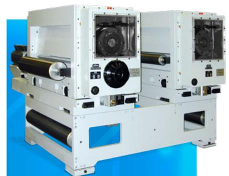
**Inline-Aggregate und Verarbeitungsanlagen Typ SPC zur Herstellung von Flüssigkeitsverpackungs-Zuschnitten oder Rollenware.**
