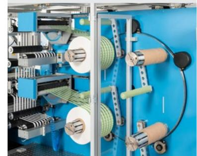
**Non-Stop Wickler** für Einzelspuren, wie z. B. Rollen für Tee-Etiketten, inkl. elektronischer Überwachung der Wickelspannung.
