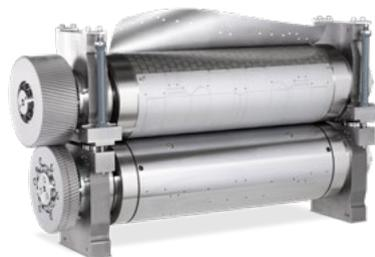
**Aggregat mit Schneidblech** zum Einbau in Druck- oder Verarbeitungsanlagen. In Abhängigkeit von Geschwindigkeit und Blechstärke können Magnete mit unterschiedlicher Haftkraft und Magnetfeld-Anordnung gewählt werden.
