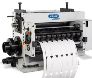
**Stanzaggregat mit integriertem Längsschneider** zur Herstellung von Eckenabrundungen für Tee-Etiketten und -Beutel. Der unmittelbare Längsschnitt nach dem Stanzen ermöglicht eine extrem genaue Platzierung der Schnittkante zum Stanzprofil.
